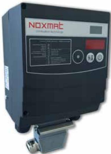
Die dezentralen Brennersteuerungen von NOXMAT verfügen über einen integrierten Gasfeuerungsautomaten und Zündtransformator zum sicheren Zünden und Überwachen der Brenner. Die angepasste Funktionssoftware ist speziell abgestimmt auf den Betrieb von NOXMAT Brennern; eine Vielzahl von Parametrier- und Diagnosemöglichkeiten ermöglicht jedoch auch den Ersatz von Steuerungen anderer Hersteller.
